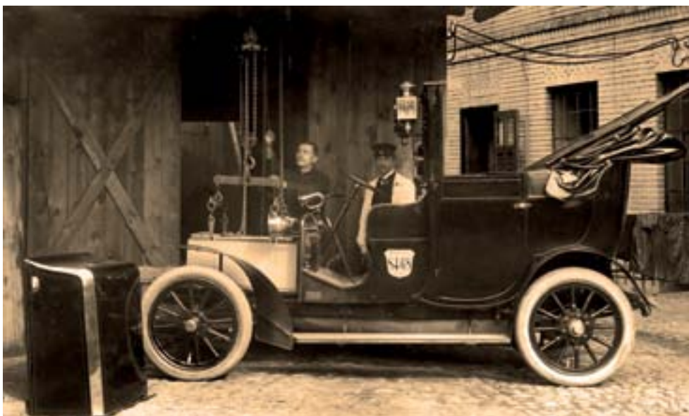
Vor 105 Jahren war die „Elektrische Viktoria“ eines der ersten Fahrzeuge, das nur mit elektrischer Energie betrieben durch Berlin rollte. Nach jeweils 80 Kilometern musste ihre 480 Kilogramm schwere Batterie aufgeladen oder mit Hilfe eines Flaschenzuges gewechselt werden.
